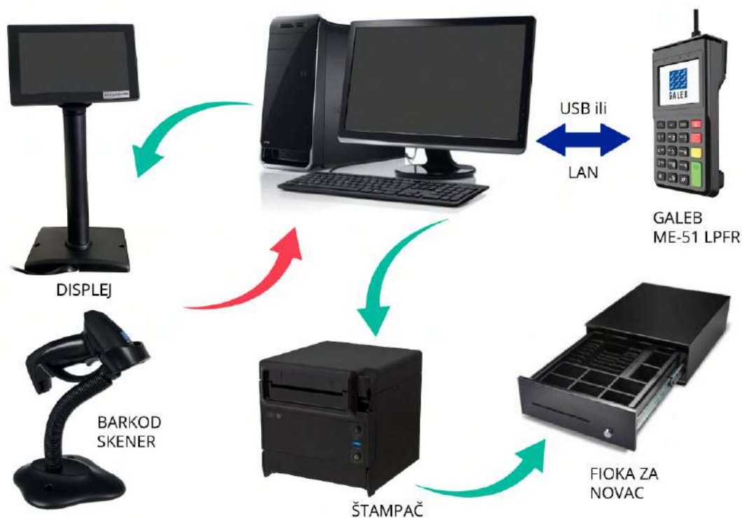
Slika 1. Predlog šeme povezivanja 1-na-1 gde se 1 ESIR povezuje sa 1 LPFR uređajem
